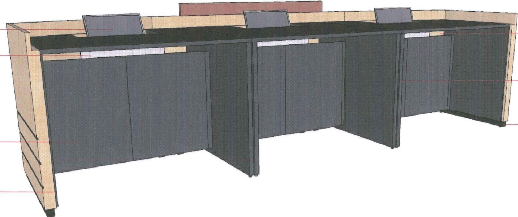
NA PARTE FRONTAL INTERNA DA ESTRUTURA, PREVER ACESSO À TUBULAÇÃO ELÉTRICA E LÓGICA, COM GUIA PARA A FIAÇÃO (01 CONJUNTO DE TOMADAS ELÉTRICA E LÓGICA POR MÓDULO)
